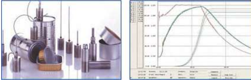
Abb. 1: Unterschiedliche, an das Produkt und seine Verpackung angepasste Messfühler (links) werden bei der Validierung eingesetzt. Die Messergebnisse werden nicht-manipulierbar dokumentiert und in Graphiken dargestellt (rechts).
