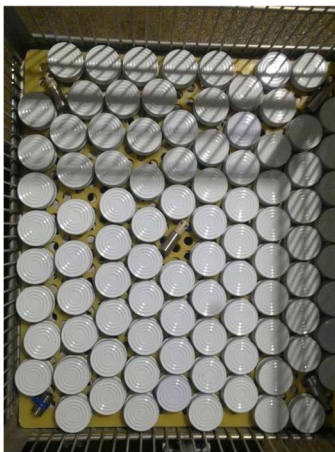
Abb. 3: Befestigung der Messfühler zwischen den wassergefüllten Behältnissen
