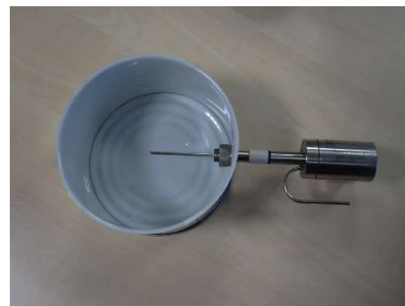
Abb. 4: Präparation eines Behältnisses für die Wärmedurchdringungsmessung
