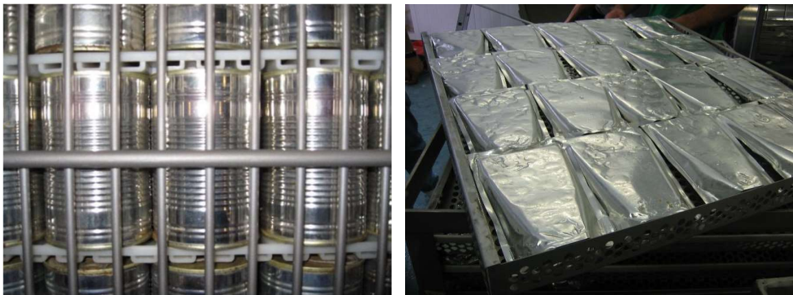
Abb. 1: Zubehör zur Optimierung der Temperaturverteilung sind z.B. gewaffelte Zwischenmatten (links) oder Spezialtrays zur Produktplatzierung (rechts)
