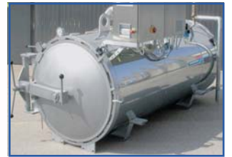
Dampf-Sprüh-Autoklaven Steam Injection Water Spray Retorts
